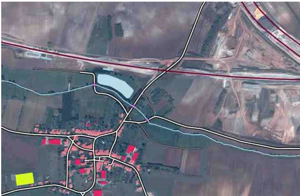
Mise à jour du RGE® IGN par saisie 3D du tracé de la LGV Est Nancy-Strasbourg
